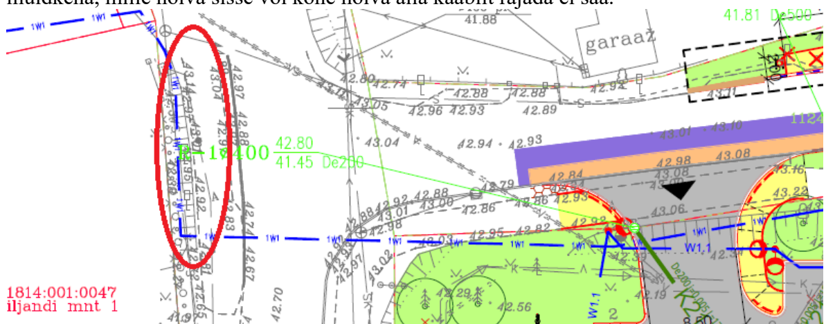
Joonis 1. Elektrikaabli väljavõtte projektlahendusest
